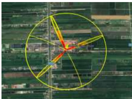
ภาพที่ 5 การจำลองการรั่วไหลของก๊าซแอมโมเนียที่บรรจุอยู่ในถังที่ 5
