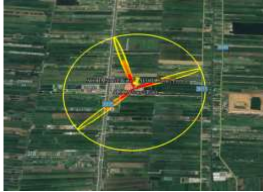
ภาพที่ 1 การจำลองการรั่วไหลของก๊าซแอมโมเนียที่บรรจุอยู่ในถังที่ 1
