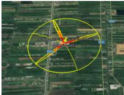
ภาพที่ 3 การจำลองการรั่วไหลของก๊าซแอมโมเนียที่บรรจุอยู่ในถังที่ 3
