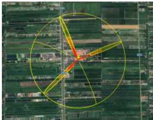
ภาพที่ 4 การจำลองการรั่วไหลของก๊าซแอมโมเนียที่บรรจุอยู่ในถังที่ 4
