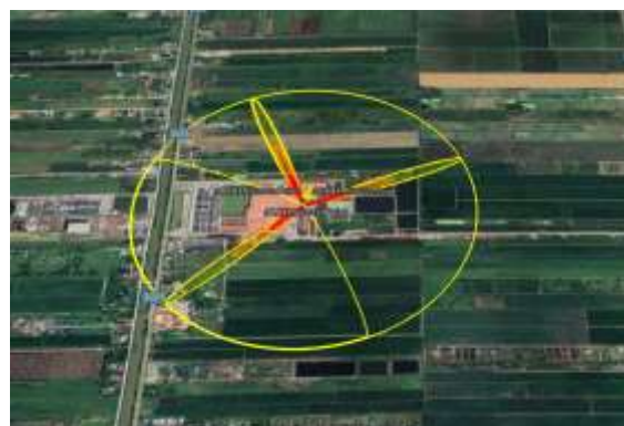
ภาพที่ 2 การจำลองการรั่วไหลของก๊าซแอมโมเนียที่บรรจุอยู่ในถังที่ 2
